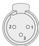
DMX-AUSGANG XLR-Montagestecker (Rückansicht)
